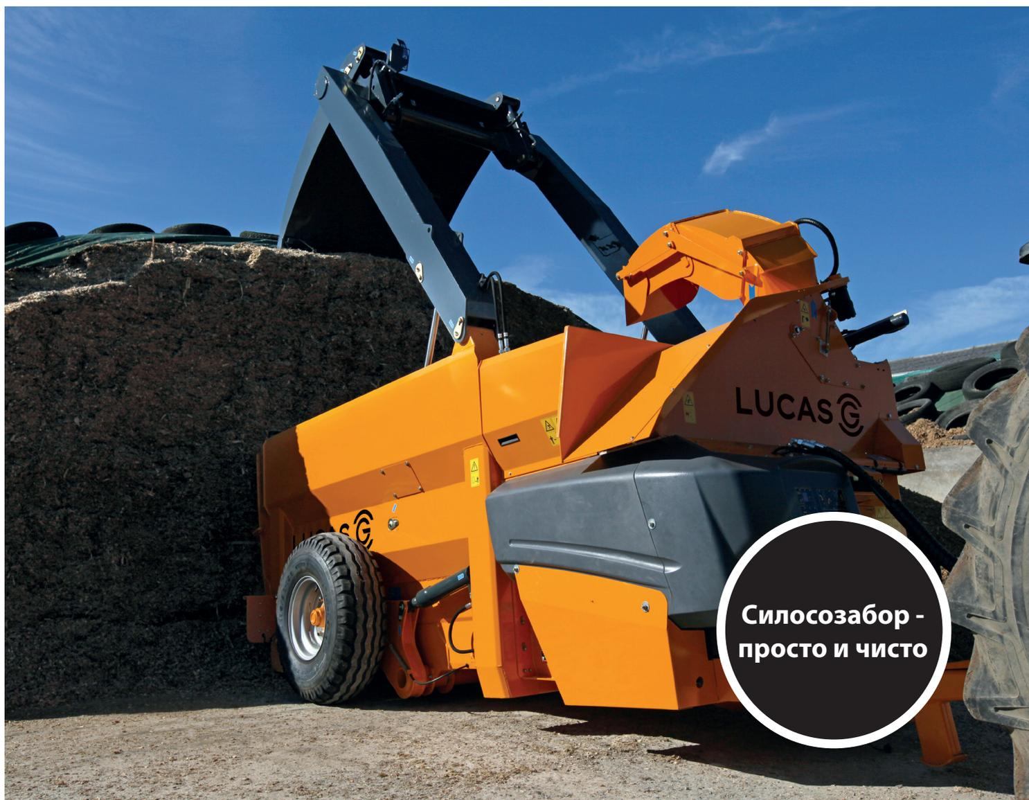
Гамма силосозаборщиков, соломовыдувателей-раздатчиков Castor G состоит из четырех моделей емкостью от 4 до 8 м<sup>3</sup>. Закругленный грейфер позволяет простую и чистую загрузку силоса из силосной ямы. После загрузки машина раздает турбиной. Castor G может быть оснащен бункером для смешивания сухих кормов, чтобы засыпать добавки к рациону.
