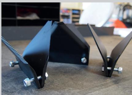
**Изогнутые ножевые секции** для сохранения абразивности разматывателя.
