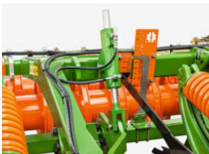
Цилиндр для регулировки выравнивающих элементов
