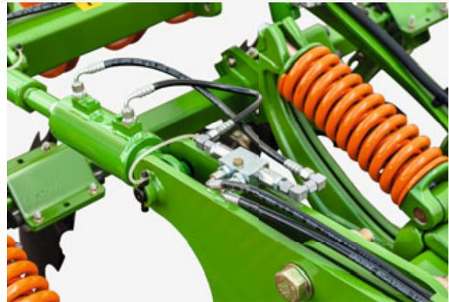
Цилиндр для настройки глубины обработки почвы
