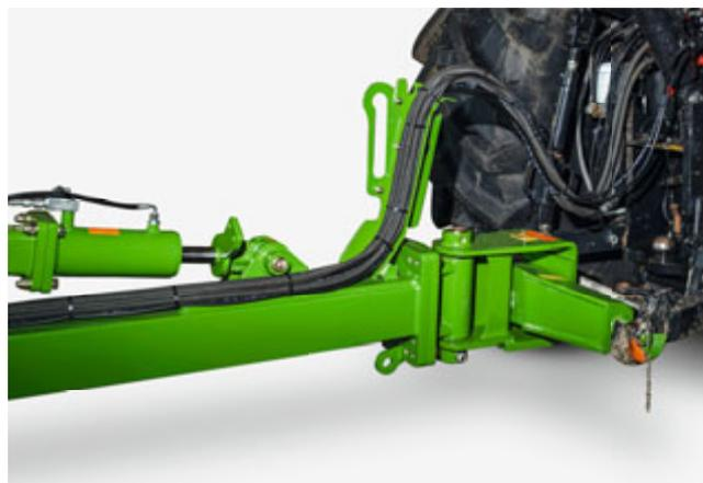
Соединение с помощью фланца – для простой и гибкой смены вариантов соединения
