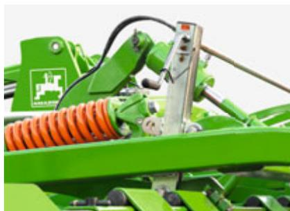
Рукоятки для централизованной регулировки выравнивающих элементов на Cenius-2TX
