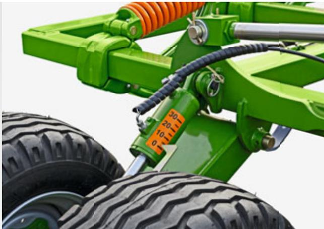
Шкала гидравлической регулировки глубины обработки стоек
