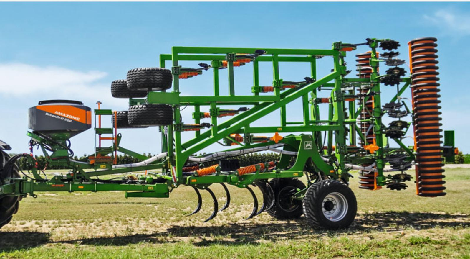
Cenius 7003-2TX Super с насадной сеялкой GreenDrill 500
