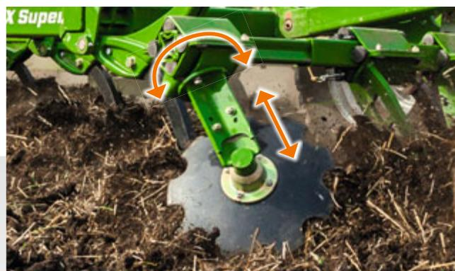
Крайний элемент – регулируется по высоте и наклону
